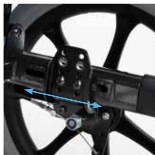
Posición de rueda trasera ajustable (9 cm) para incrementar la maniobrabilidad o la estabilidad de la silla.
